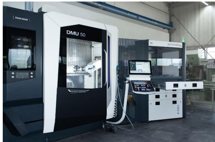
Abb. 1: X-CELL WB10 von ZELTWANGER angekoppelt an der DMG DMU 50 bei Jucowa Metallbearbeitung GmbH
